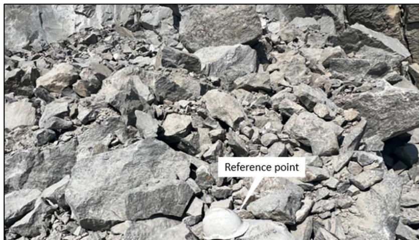
D4: Blast # 4 – Actual muckpile fragmentation
