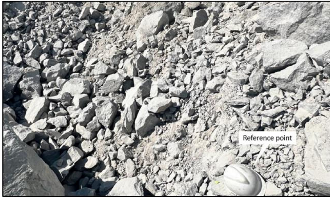
D3: Blast #3 – WipFrag fragmentation results and the actual muckpile
