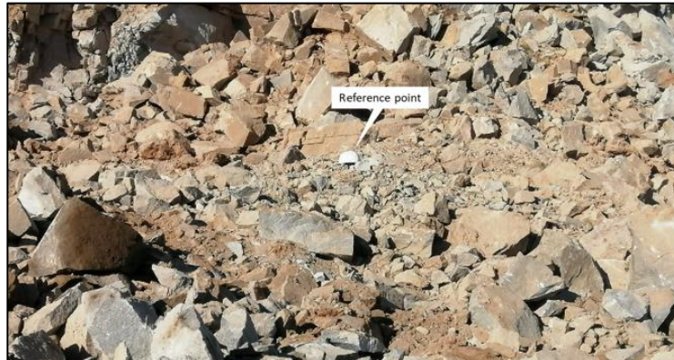
D4: Blast # 4 – Actual muckpile fragmentation
